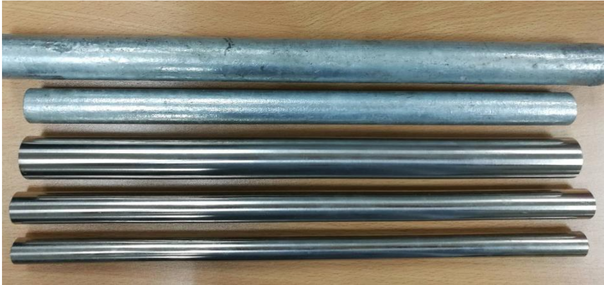
รูปที่ 4 ตัวอย่างท่อประปาเคลือบสังกะสีและท่อเหล็กกล้าไร้สนิมกลมที่ใช้ในงานโครงสร้าง
