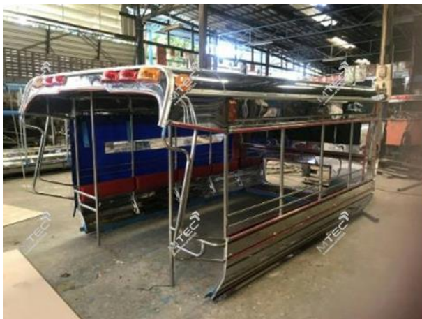
รูปที่ 34 ต้นแบบหลังคาห้องโดยสารในลักษณะโมดูล (ซ้าย) และการประกอบต้นแบบเข้ากับรถกระบะ (ขวา)
