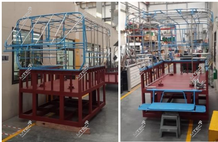
รูปที่ 19 ต้นแบบ Full scale ที่ใช้ในการจำลองต้นแบบหลังคารับส่งนักเรียนประเภทกระบะดัดแปลง
